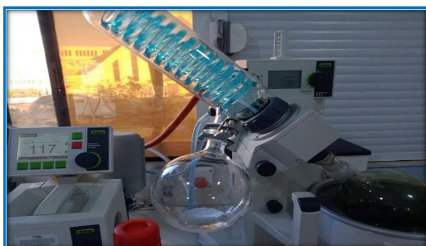
**Figure 5:** Évaporation par rotavapor
